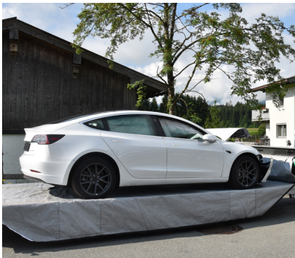
Coloque el vehículo eléctrico en la manta de seguridad
