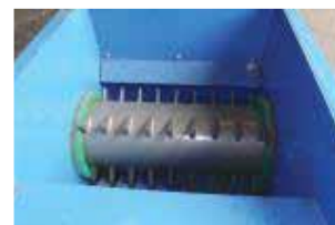
PERFORADOR Debe utilizarse al procesar botellas de PET sin perforar.
